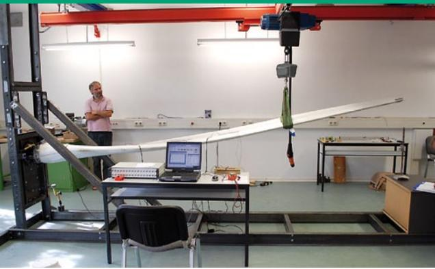
Prüfstand für kleine Windanlagenflügel
